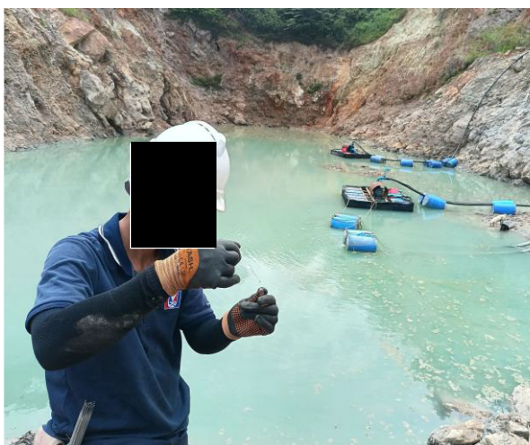
รูปที่ 2-34 (ต่อ) การทดสอบความเข้มข้นของฟลูออไรด์ ด้วยชุดทดสอบภาคสนาม (Test Kit) บริเวณ บ่อ 1
